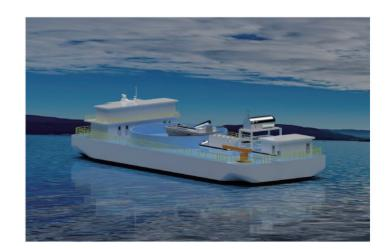
船舶运营于滇池水域,进行蓝藻打捞处理工作。航行过程全电池动力运行,大幅降低能耗,并实现零排放。蓝藻打捞过程中使用LNG发动机,满足大功率用电需求的同时实现了更优的排放。
