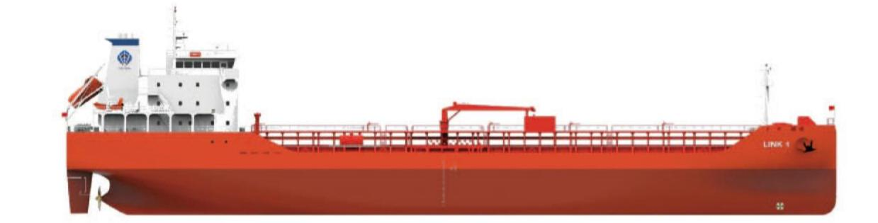
船舶大部分时间航行在沿海及近洋区域,有时进入内河航行,全航行过程综合能耗降低5%以上。在沿海排放区时采用全电池动力运行,减少发动机 低负荷运行时间,降低能耗,提升操纵性能,实现零排放。船舶进入内河时,采用配置有SCR的发电机组电力推进型式,既满足了功能需求,符合排放 法规规定,又减少了整体成本。
