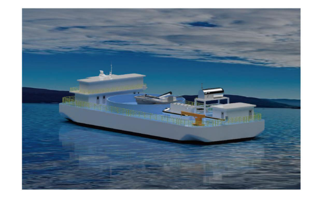
船舶运营于滇池水域,进行蓝藻打捞处理工作。航行过程全电池动力运行,大幅降低能耗,并实现零排放。蓝藻打捞过程中使用LNG发动机,满足大功 率用电需求的同时实现了更优的排放。
